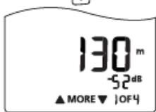
第一个接点的反射是 -52 dB。接入光纤长度是 130 m。
