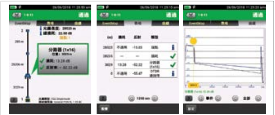
圖 4. PON OTDR 結果畫面範例
